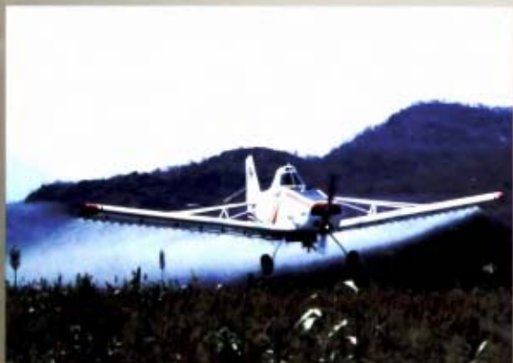
Prototipo del primer avión fumigador Chac, construido en colaboración con la Dirección General de Aeronáutica Civil, el IPN y la Asociación de Profesionistas e Ingenieros en Aeronáutica. Se hicieron tres prototipos y fueron certificados.
