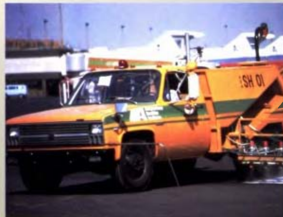
Prototipo de vehículo pintarrayas, proyecto de tesis realizado por alumnos de la Licenciatura en Diseño Industrial de la UNAM
