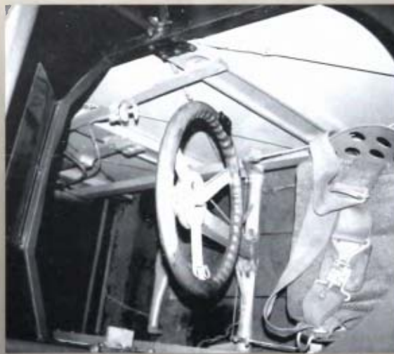
Interior del avión Serie H, en el que puede apreciarse los mecanismos de operación de la aeronave.
