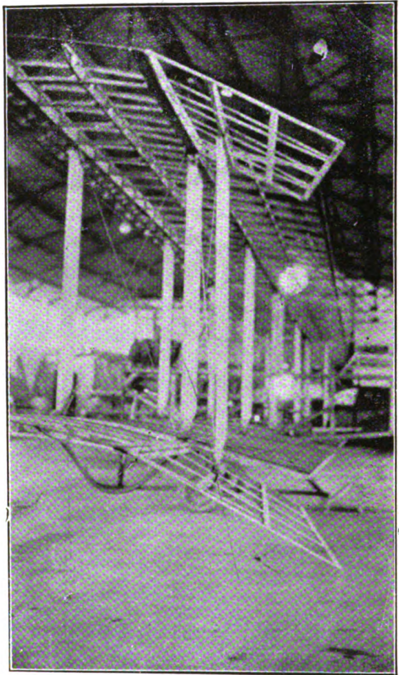
Armazón de un biplano en construcción en los Talleres Nacionales de Construcciones Aeronáuticas. En el grabado puede verse el complicado esqueleto de estos pájaros de acero.
