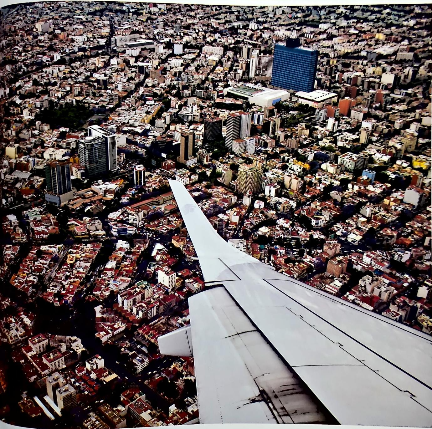
Un ERJ-190 de Aeroméxico Connect sobrevuela la ciudad de México. Los *winglets* o dispositivos de punta alar, como los de esta aeronave, reducen su resistencia aerodinámica, lo que contribuye a una mayor eficiencia en el consumo de combustible.
