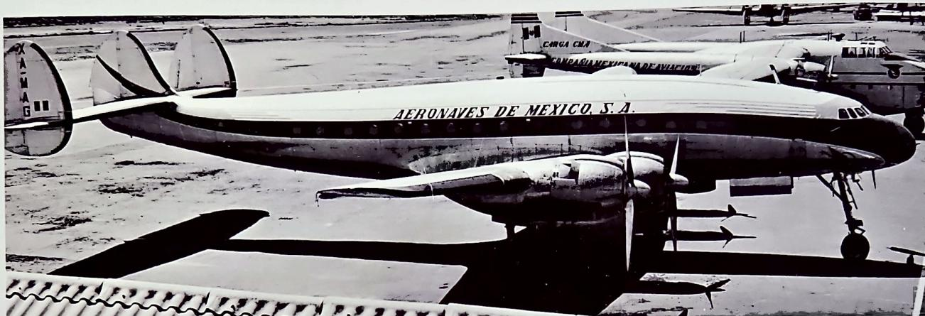
Los aviones Constellation producidos por la empresa norteamericana Lockheed Aircraft Corporation constituyen un notable caso de longevidad, gracias a su diseño original, eficiente y estructuralmente fuerte que permitió una evolución de la célula básica en una serie de modelos posteriores, cada uno de ellos más moderno, más grande y más veloz.
